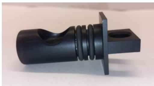
Figura 16 - Cassetto porta campione per entrambe le celle. Si notino i due o-ring.
