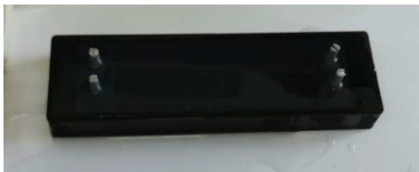
Figura 2 - Inglobamento del sensore in stampo a cielo aperto
