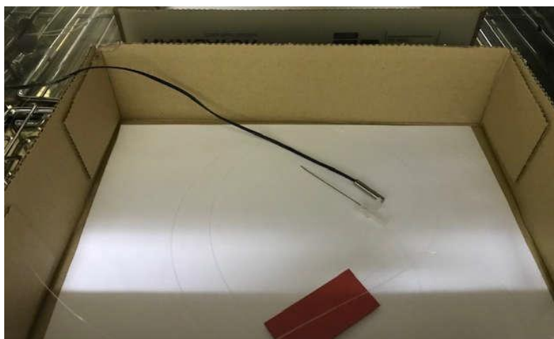
Figura 14 - Foto del set-up sperimentale per la misura della sensibilità termica
