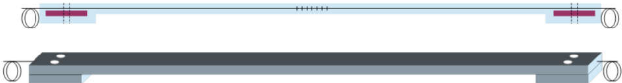
Figura 4 - Disegno concettuale del sensore inglobato in sagomato con piastrini
