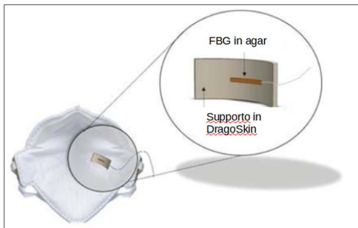
Figura 7 – Mascherina FFP2 strumentata con sensore FBG.
