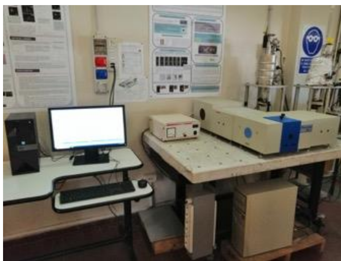
Figura H7 - Fotografia dello spettrofluorimetro Fluorolog-3 Modello FL3-11 acquisita dopo l'implementazione.
