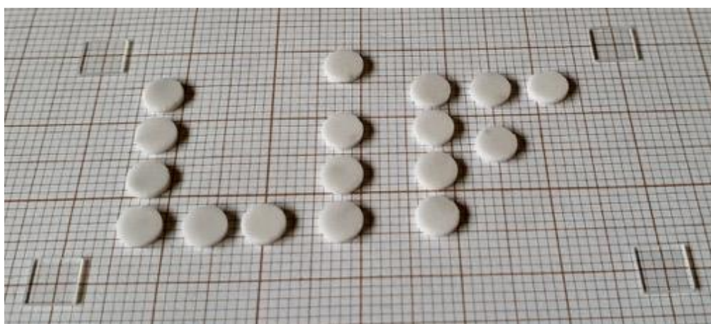
Figura 7- Cristalli (trasparenti) e pasticche (opache) di LiF
