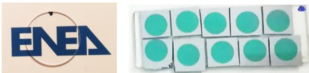
Figura 1- a) Film di LiF di spessore nominale 600 nm su Suprasil diametro 25.4 mm; b) array di film di LiF, diametro 10mm, su Si(100), utilizzati come rivelatori di radiazione
