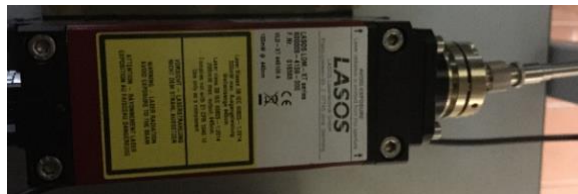
Figura H6 - Laser diode module MOD. VLD-XT 445100 A accoppiato con fibra monomodale di uscita
