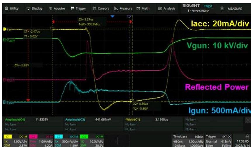
Figura 5. Tracce all'oscillografo durante l'operazione della macchina: in giallo la corrente all'uscita del linac (Iacc), in verde la tensione del cannone elettronico (Vgun); in magenta il segnale proporzionale alla potenza riflessa dalla struttura accelerante (Reflected Power); in blu la corrente prodotta dal cannone (Igun) iniettata nel linac.
