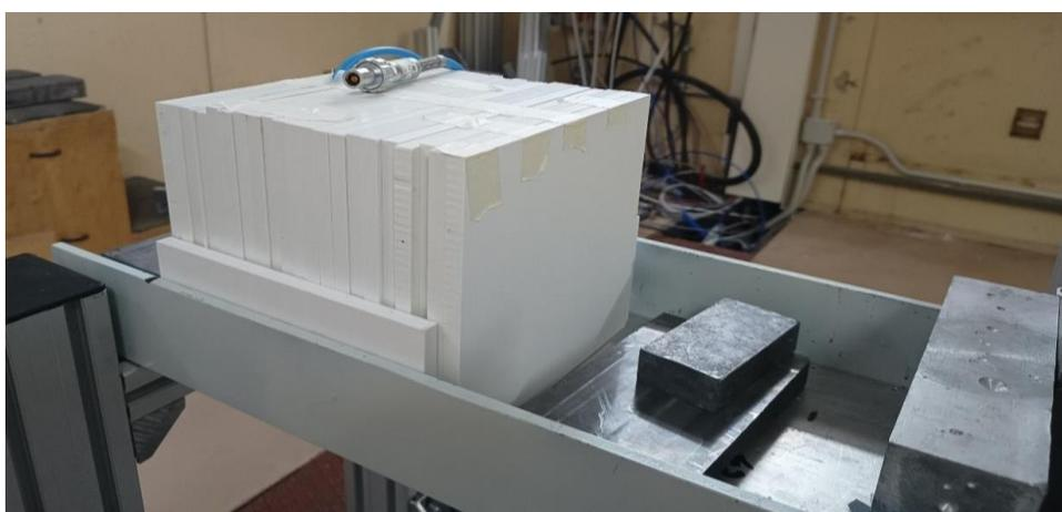
Figura 9. Setup per la misura della curva PDD.
